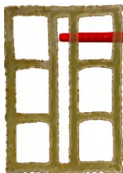
شکل ۴۷-۱۲- لزوم درگیر شدن رول‌پلاگ با حداقل دو بدنه بلوک سفالی
