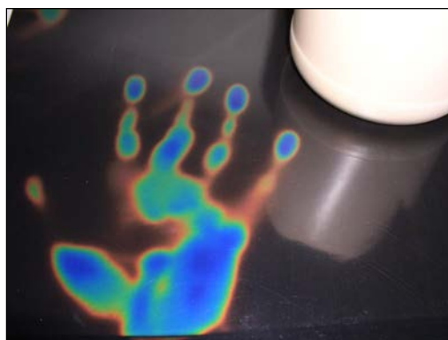
شکل ۱۲-۷۳- نمونه تغییر رنگ شیشه‌های ترموکرومیک در اثر گرمای دست
