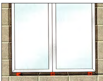
شکل ۱۲-۵۴- جانمایی لاتن‌های بستر چارچوب
